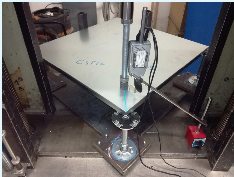
Fotografia di una porzione di pavimento sopraelevato durante la prova con carico applicato in diagonale a 70 mm dal bordo della testa della colonna.
